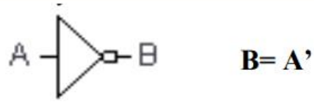
DEĞİL (NOT) kapısı sembolü, çıkış ifadesi
